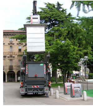
Opération de manutention de bacs enterrés (Source : Cete Méditerranée)
