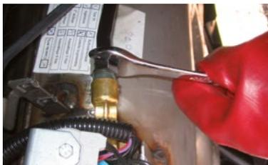
Décompresser le circuit en desserrant un raccord sur le circuit d'emplissage du réservoir.
