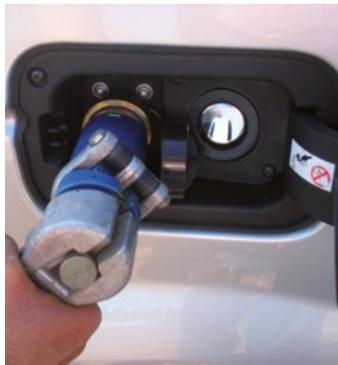
Repousser le GPL contenu dans le tuyau d'alimentation par 3 injections successives d'azote à 1,2 MPa (12 bars). La bouteille étant refermée, brancher 3 fois le pistolet pour décharger le flexible ; la pression résiduelle affichée est la pression régnant dans le réservoir (en fonction du volume de la canalisation).
