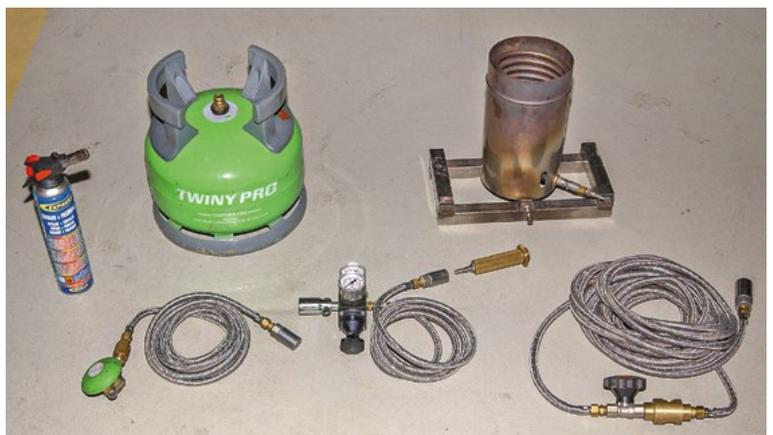
Un test à 0,1 et 1,2 MPa (1 et 12 bars) est effectué sur le réservoir pour tester l'étanchéité de l'assemblage accessoires/réservoir. À l'issue du test, le réservoir sera purgé de son azote puis gazé ou mis au vide\* (0,05 MPa soit 0,5 bar) avant remontage sur le véhicule. On testera l'ensemble du véhicule selon l'un des deux modes opératoires précédents.
